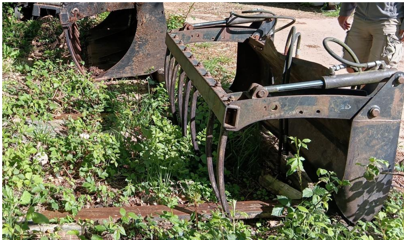
Grappin à fumier transformé en grappin à branches par Fabien pour organiser les tas de bois destinés au broyage
