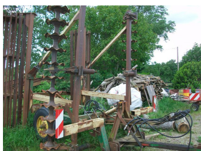
« Rolloxitan » composé de disques gaufrés à l'avant et de rouleau à l'arrière - utilisation pour le découpage des cannes
