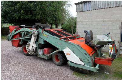
Machine automotrice de ramassage des pommes au sol
