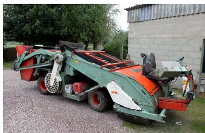
Machine automotrice de ramassage des pommes au sol
