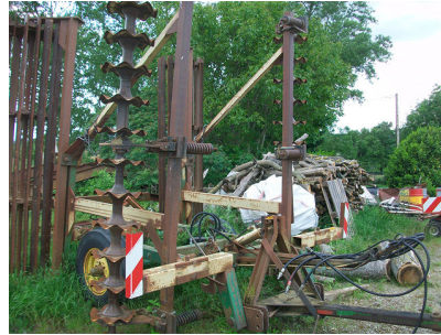
« Rolloxitan » : disques gaufrés à l'avant et rouleau à l'arrière – pour le découpage des cannes
